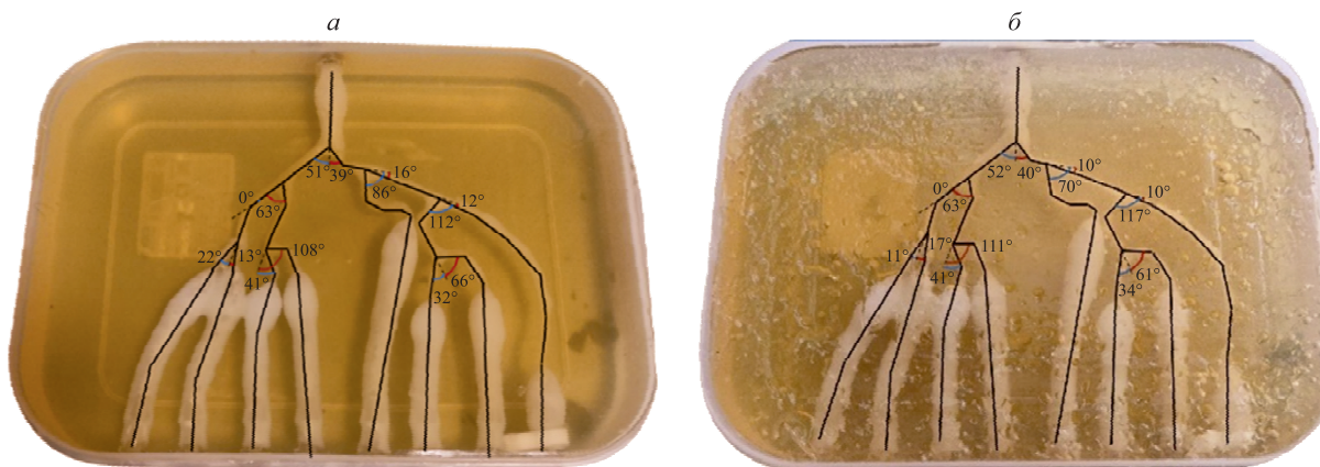
Рис. 4. Углы отхождения дочерних ветвей коронарной артерии до (а) и после установки стента (б)
