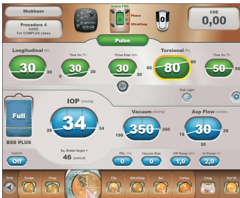
Рис. 1. Настройки факоэмульсификатора для аспирации фрагментов ядра хрусталика
